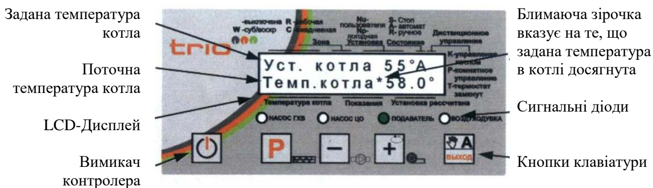
Рисунок 2 – Зовнішній вигляд передньої панелі контролера
