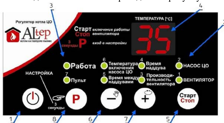
Рисунок 3 – Зовнішній вигляд передньої панелі контролера
